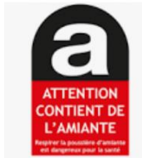
Figure 151 - Etiquette amiante à coller sur chaque type de conditionnement (sur au moins 2 faces visibles)
