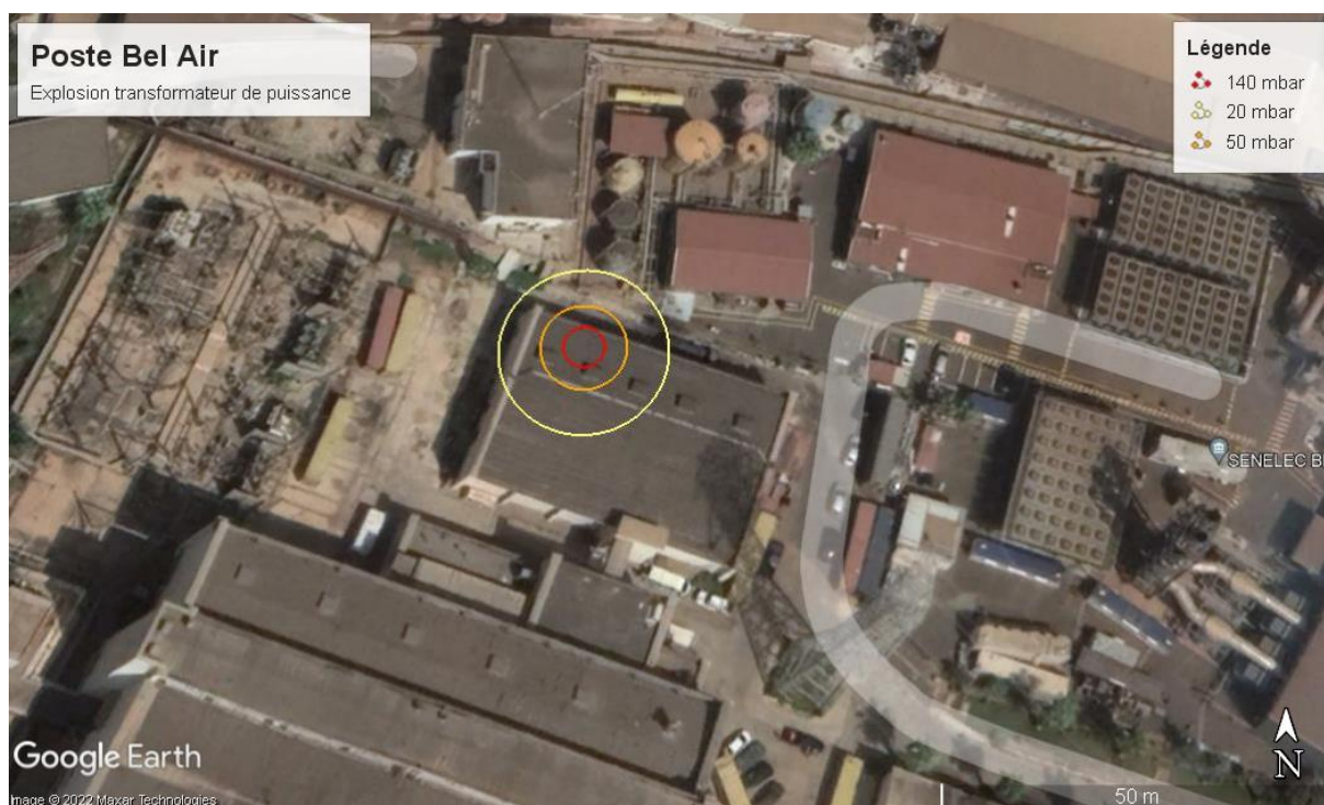
Figure 138 - Représentation graphique de l'explosion d'un nouveau transformateur dans le poste de Bel Air
