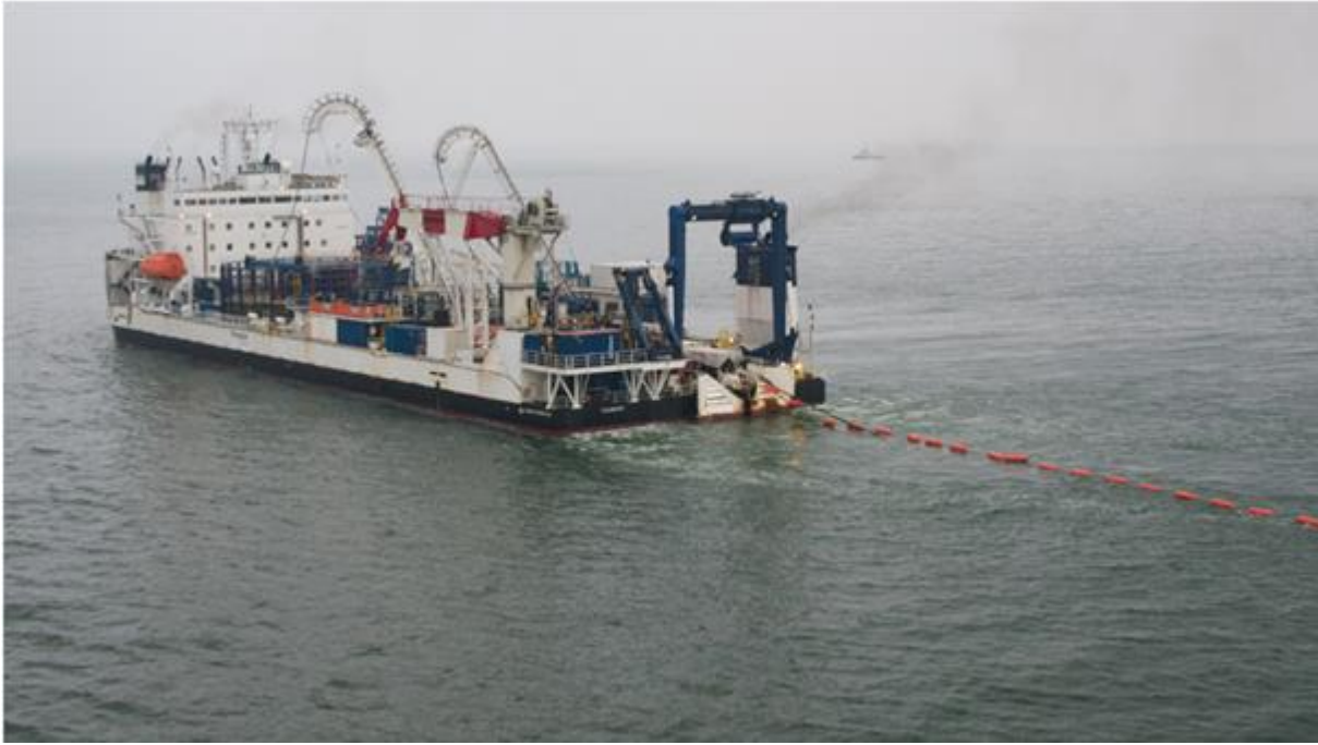
Photo 1 - Navire câblé déployant un câble sous-marin à distance d'un point d'atterrage (RTE, 2019)
