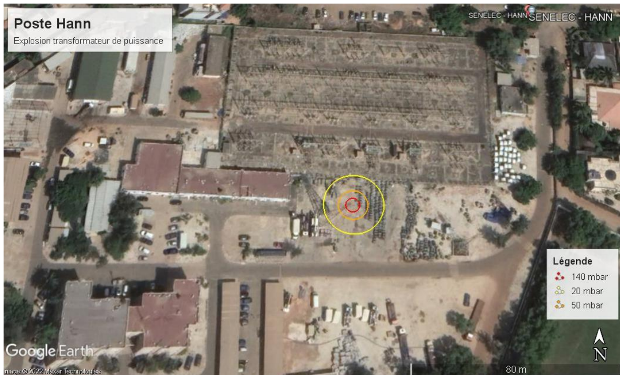
Figure 139 - Représentation graphique de l'explosion d'un nouveau transformateur dans le poste de Hann
