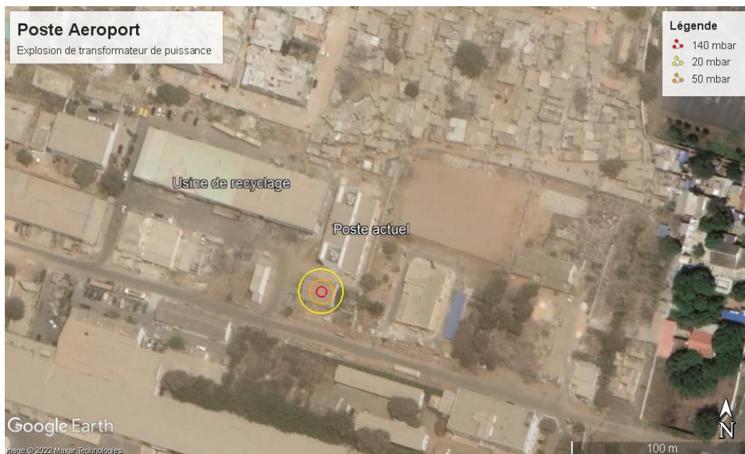
Figure 140 - Représentation graphique de l'explosion d'un nouveau transformateur dans le poste de l'aéroport
