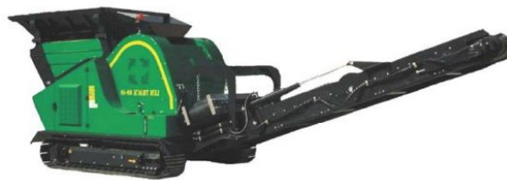
Photo 91 - Groupe mobile de concassage et recyclage d'agrégats (Source : Maitek)
